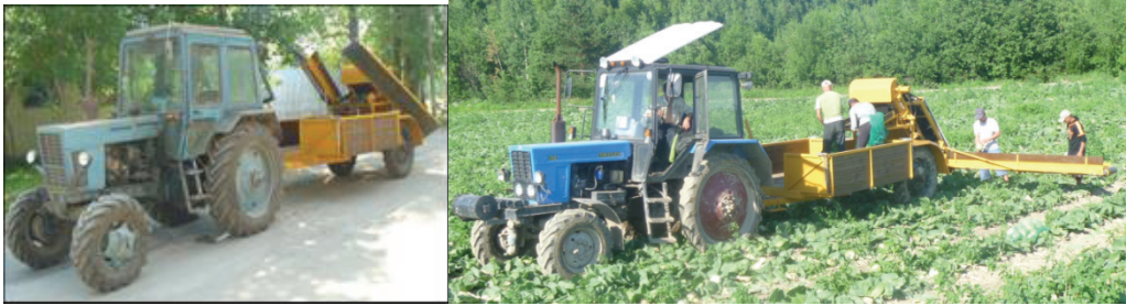
транспортное положение агрегата рабочее положение агрегата Рисунок 2 - Агрегат для выборочной уборки не одновременно созревающих овощей
