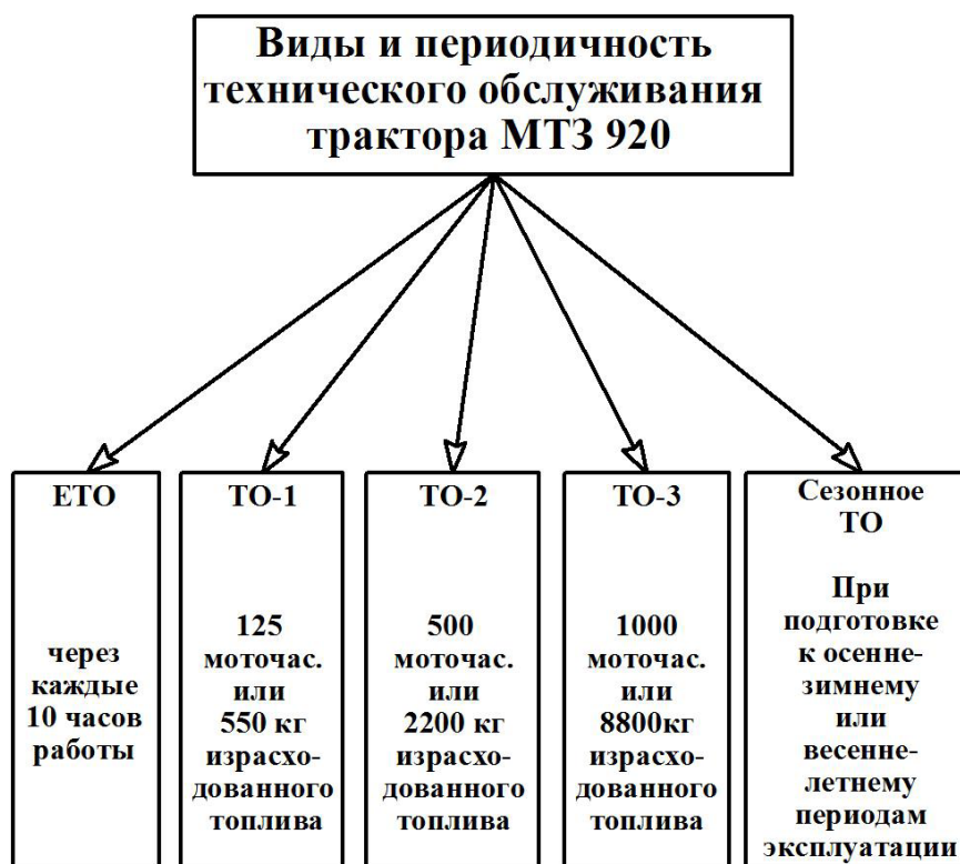
Рисунок 4. Карта потока вида и периодичности технического обслуживания трактора МТЗ-920
