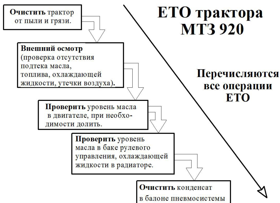
Рисунок 3. Карта потока выполнения ежедневного технического обслуживания (ЕТО) трактора МТЗ-920
