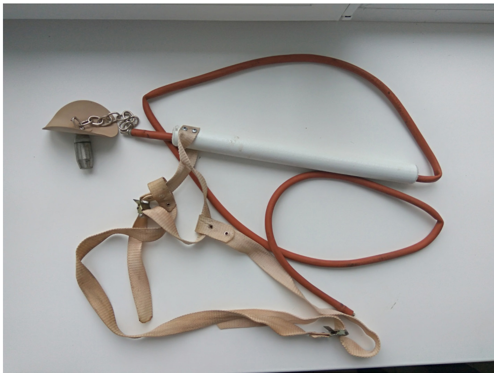
Рисунок 2 – Модель усовершенствованного магнитного зонда
