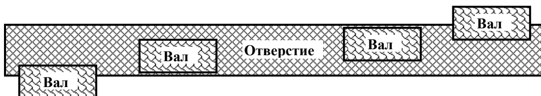
Рис. 43. Графическое отображение переходной посадки
