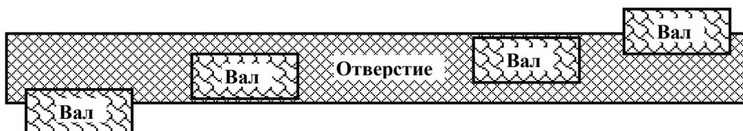
Рисунок. 43 - Графическое отображение переходной посадки
