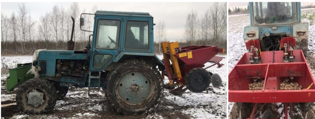
Рисунок 7 – Опытный агрегат для посадки картофеля с локальным внесением органических удобрений
