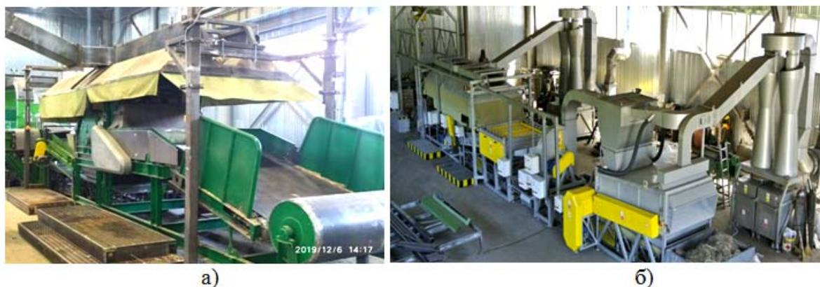
Рисунок 4 – Линии переработки лубяных культур в волокно однотипное ЛПЛ производства ТОВ «Хемптехно» (Украина)
