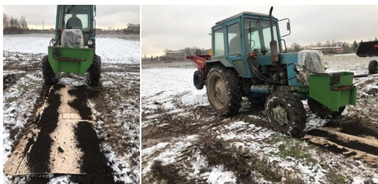
Рисунок 2 – Опыт при линейном динамическом перемещении трактора
