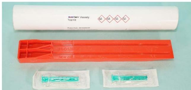
Рисунок 3 – Внешний вид экспресс-тестер вязкости *Mobil Serv<sup>SM</sup> Flostick*
