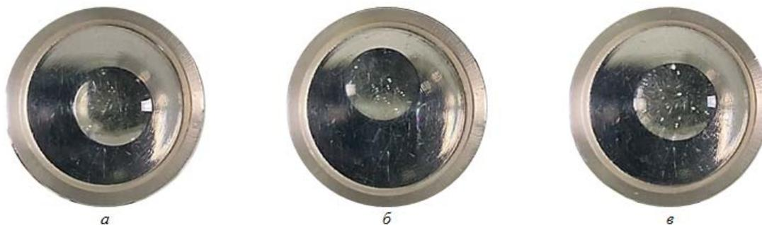
Рисунок 3 – Результаты апробации свежего моторного масла марки Лукойл Авангард 10W40 с различным количеством искусственно введенной воды:
