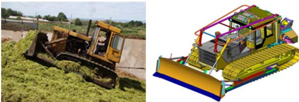
Рисунок 1 – Процесс трамбовки в силосной траншее и схема рамы гусеничного трактора с навесным рабочим органом
