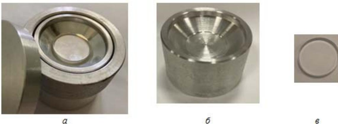
Рисунок 1 – Электротигель ЗИВ с дополнительными вставными элементами для определения наличия и количества воды в моторном масле:
