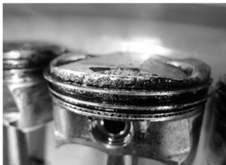
Рисунок 1 – Нагарообразование на головке поршня
