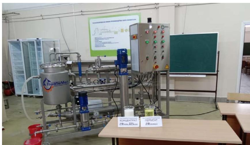
Рисунок 1 – Пилотная ультрафильтрационная установка
