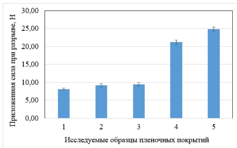
Рис.3. Изменение приложенной силы при разрыве образцов пленочных покрытий
