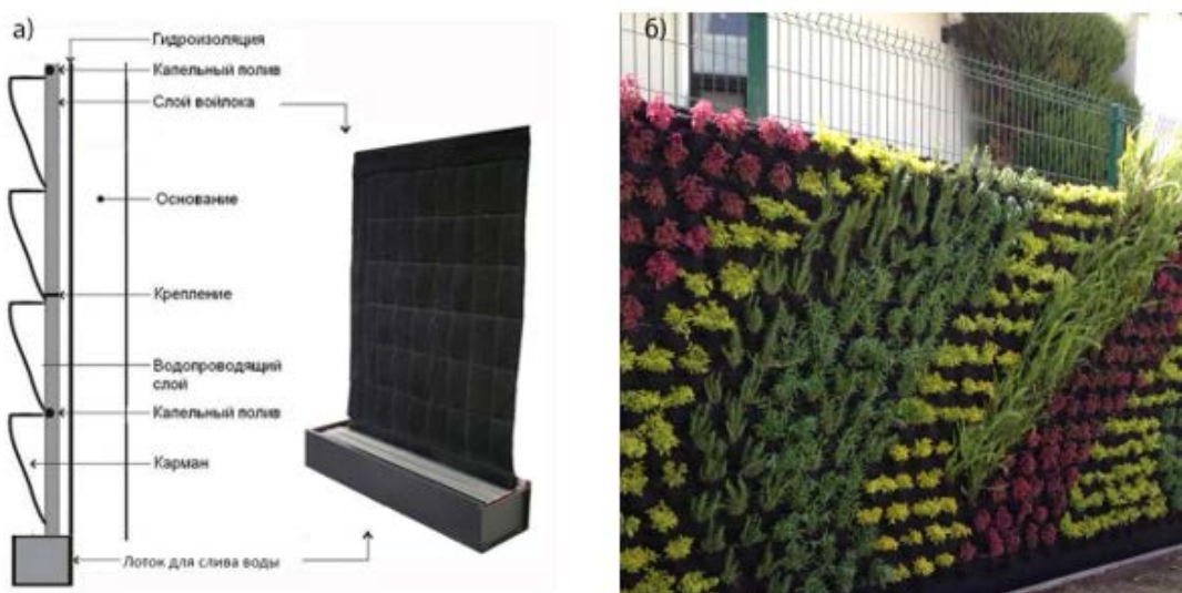
Рис. 2. Схема (а) и пример (б) войлочной системы вертикального озеленения
