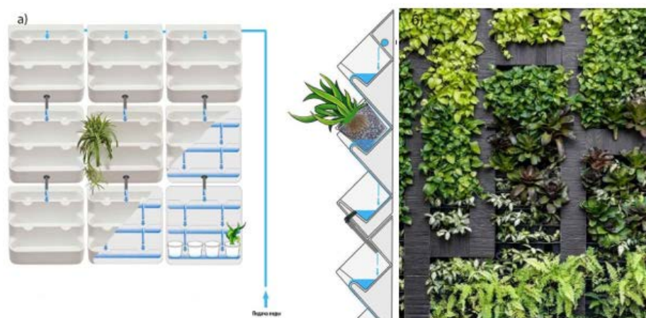
Рис.4. Схема (а) и пример контейнерной системы вертикального озеленения
