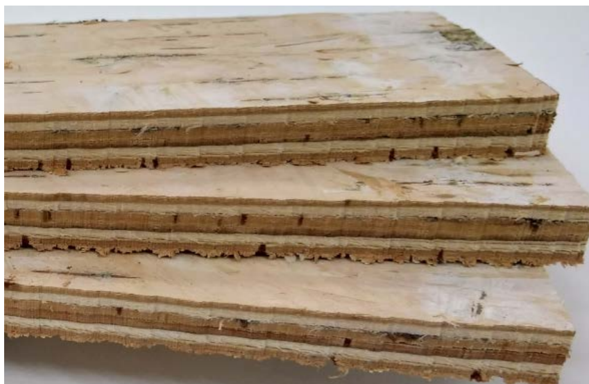
Рис.1. Многослойный плитный материал с использованием бересты
