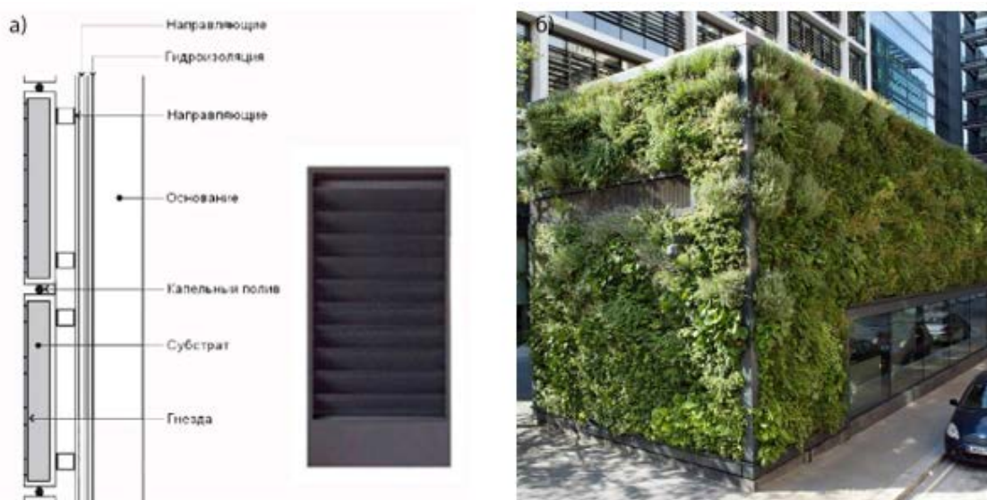
Рис. 3. Схема (а) и пример (б) модульной системы вертикального озеленения
