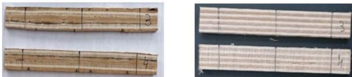
Рис. 2. Образцы плитного материала с использованием бересты и образцы фанеры марки ФК
