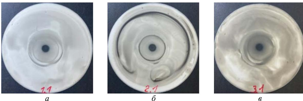
Рисунок 2 – Внешний вид фильтрограмм моторных масел Лукойл Авангард 10W40 с различной наработкой:
