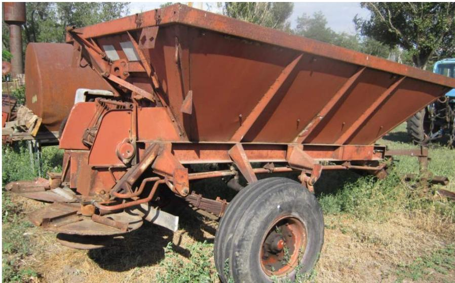
Рисунок 3– Коррозионные разрушения разбрасывателей минеральных удобрений
