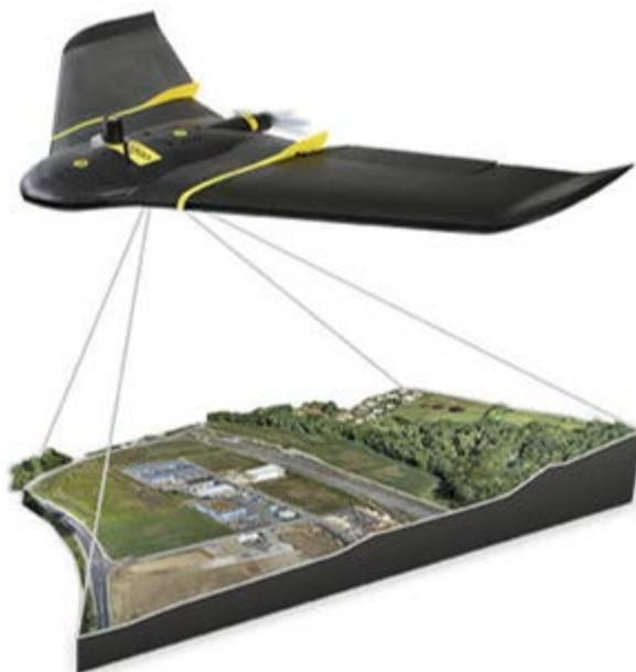
Рисунок 1 – Дрон самолетного типа eBee Plus
