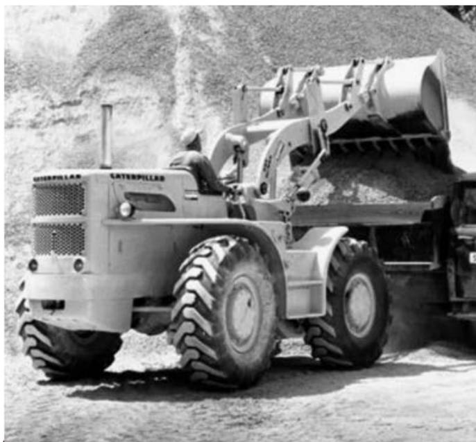
Рисунок 2 – Трахсаватор 944 модели
