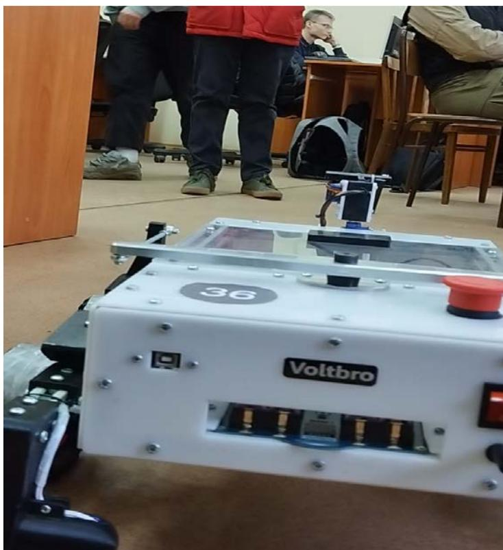
Рисунок 3 – Робототехническая платформа Voltbro Brover E-4
