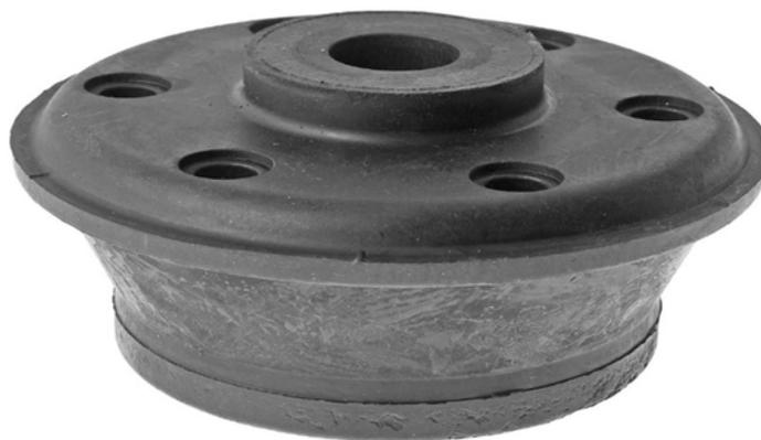
Рисунок 3 – Виброизолятор кабины трактора МТЗ 82
