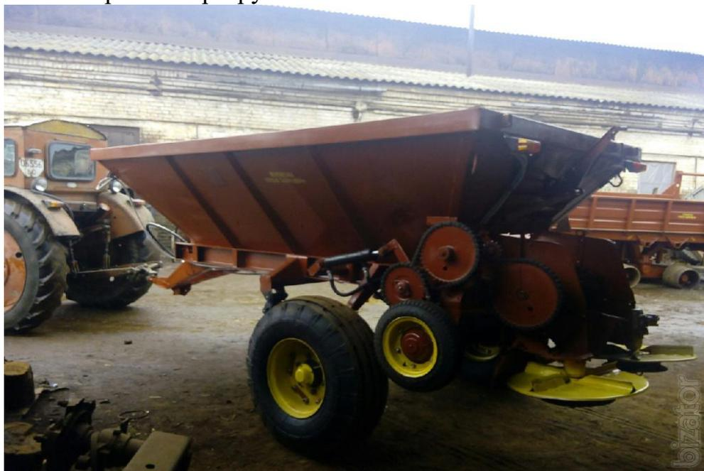
Рисунок 1 – Машина для внесения минеральных удобрений 1-РМГ-4
