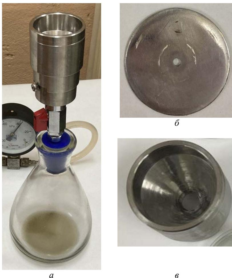
Рисунок .1 – Модернизированная установка для патч-тестирования:
