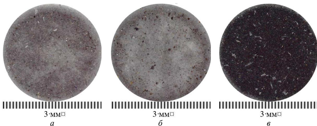
Рисунок 5 – Изображения центрального участка фильтрограмм моторных масел Лукойл Авангард 10W40 с различной наработкой, полученные с помощью микроскопа *Discovery Artisan 32*, подключенного к ноутбуку:
