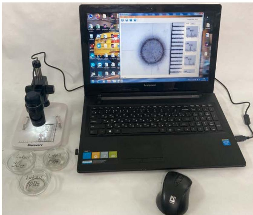
Рисунок 4 – Внешний вид портативного цифрового микроскопа *Discovery Artisan 32*, подключенного к ноутбуку
