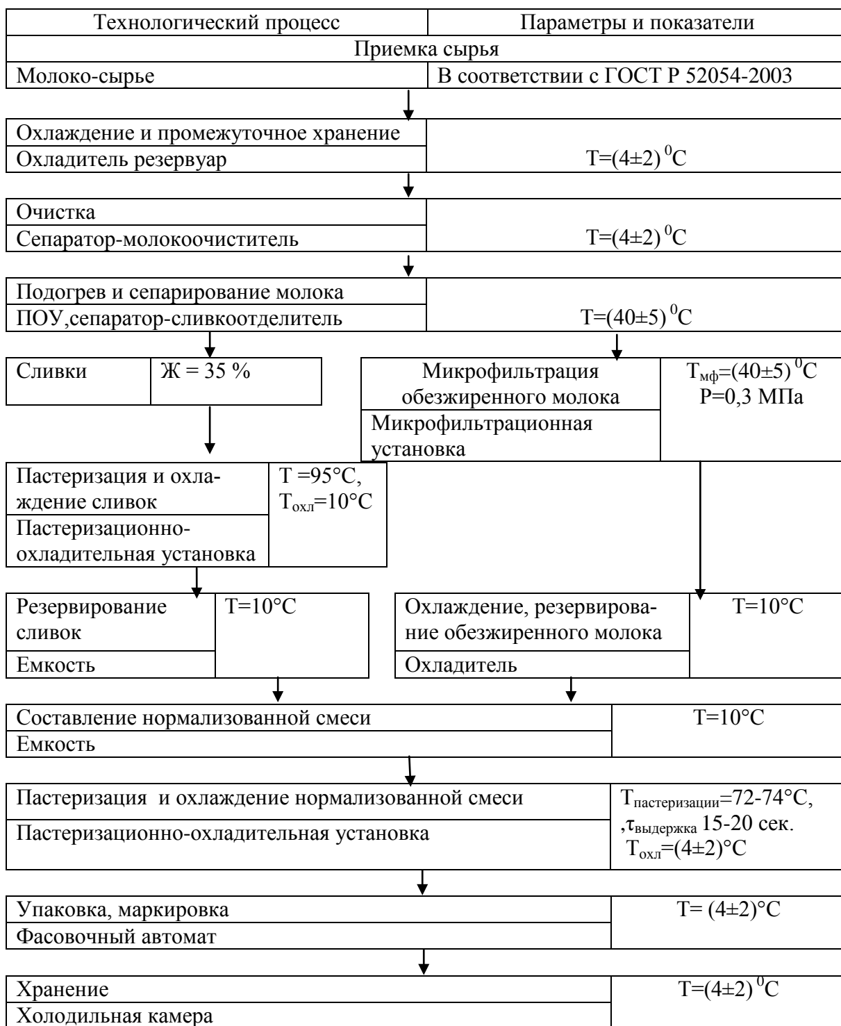
Рис.1. Схема производства питьевого пастеризованного молока со сроком годности 20 суток.
