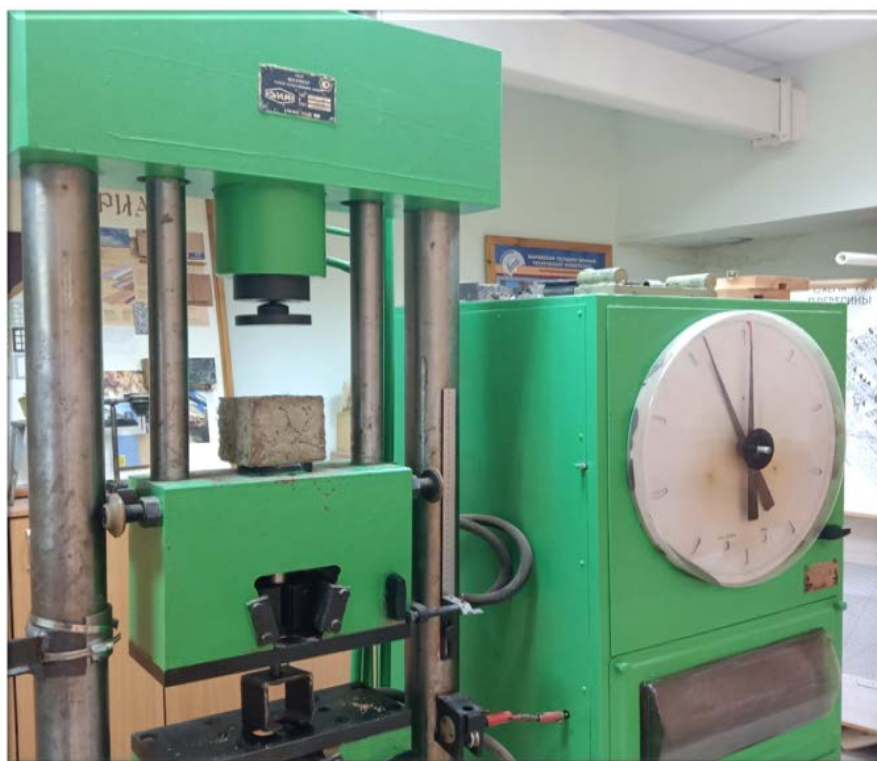
Рисунок 2 – Испытание образца на сжатие
