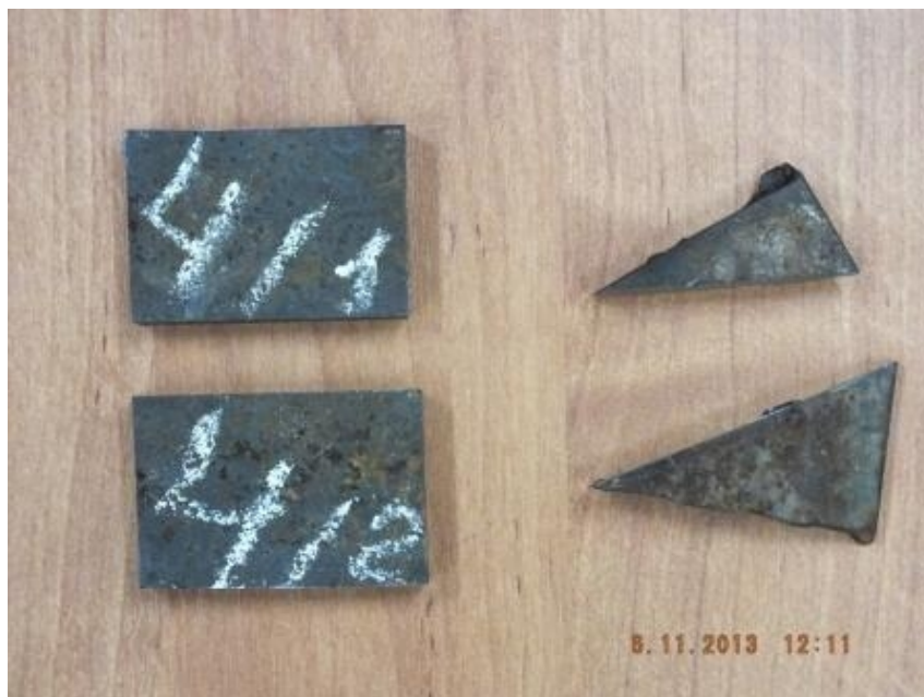
Р и с. 1. Образцы стали Hardox, и элемент рессоры прицепа ЛТГ-4
