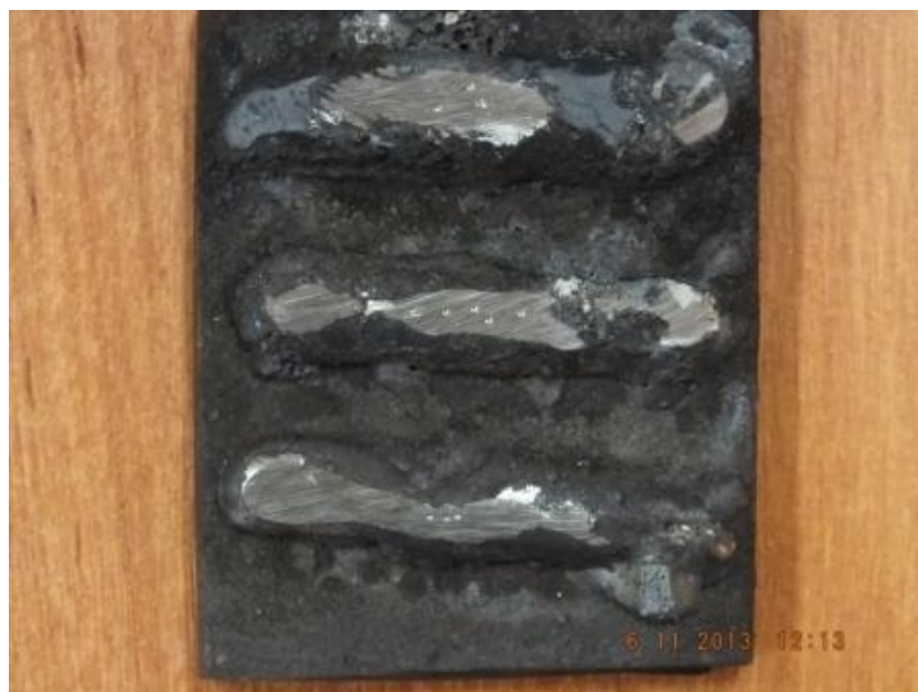
Р и с. 4. Образец после измерения твердости НРС
