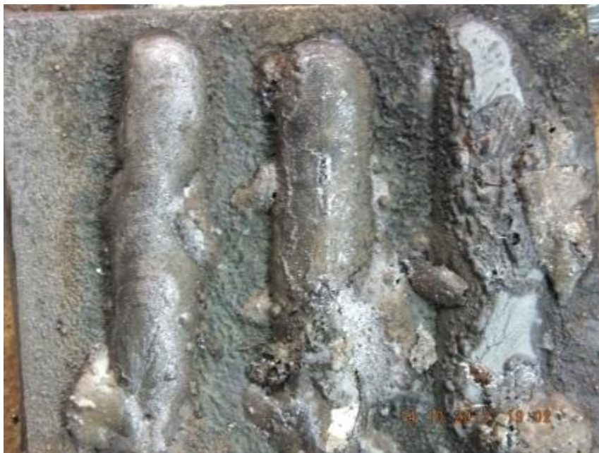
Р и с. 3. Образец наплавленного металла, сварочные электроды АНО-4.
