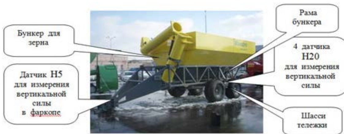
Рис.1. Общий вид бункера-перегрузчика ООО «Лилиани»
