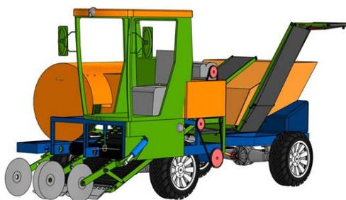
Рисунок 1 – 3 D модель картофелеуборочного комбайна «Муравей» 70С
