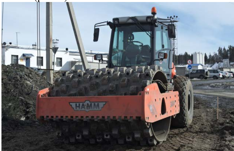
Рис. 1. Грунтовый каток Hamm 3414 НТР
