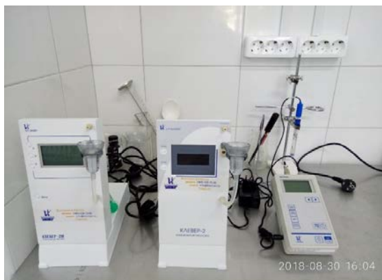
Рис. 2. Анализаторы молока «Клевер-2», «Клевер-2М», рН-метр-термометр «Нитрон-рН»
