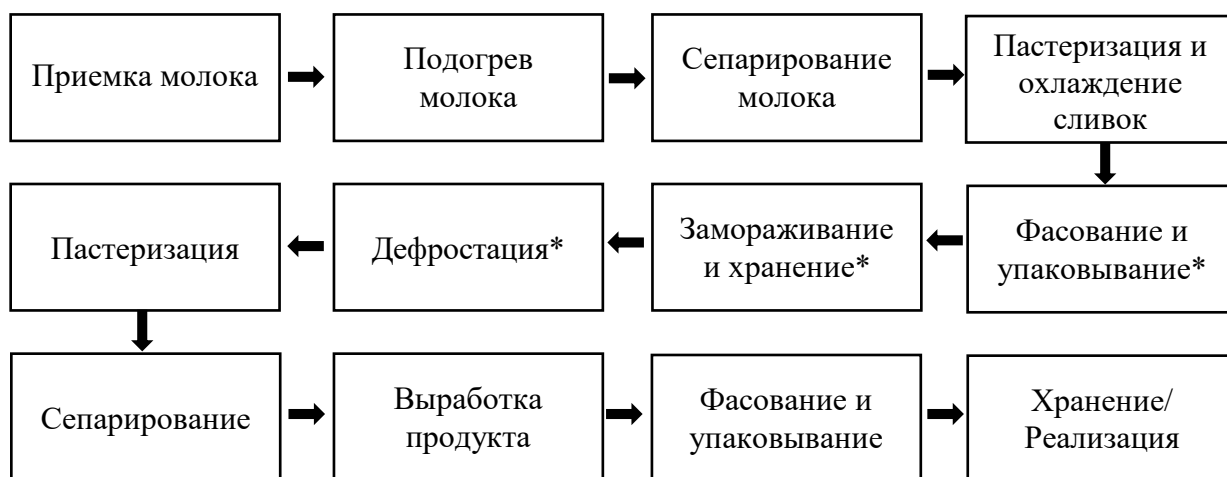
Рисунок 1 – Технологическая схема производства масла сливочного из замороженных сливок
