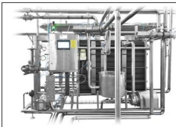
Рисунок 2 – Оборудование для охлаждения молочных продуктов, использующее технологию LLFF
