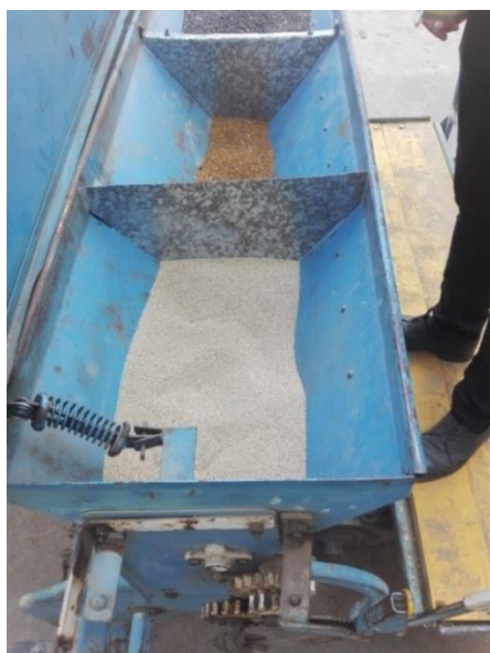
Рисунок 1 – Семенной бункер сеялки СН–16 с отсеками
