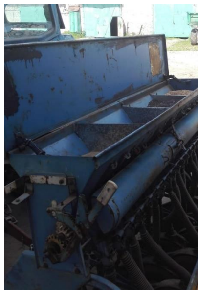
Рисунок 1 – Семенной бункер сеялки СН–16 с отсеками
